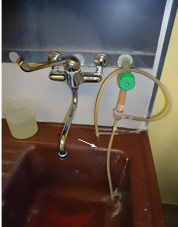
FIGURA 1 Sistema a vácuo para aspirar o sobrenadante das amostras de urina centrifugadas.
