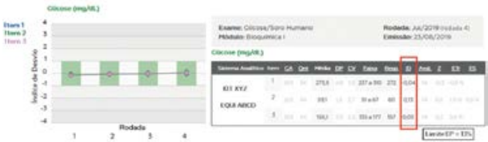
FIGURA 4 Gráfico de acompanhamento (índice de desvio) e Relatório de Avaliação de glicose (soro) do laboratório utilizado no exemplo.
