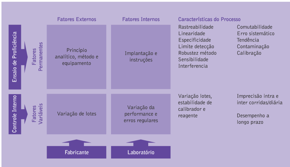
Figura 2: Relação do ensaio de proficiência (EP) e do controle interno (CI) com fatores e características do processo analítico.
